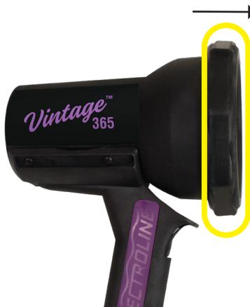
Le filtre en verre reste à l'intérieur du protecteur. Pour retirer le filtre en verre Borofloat®, relevez le bord du couvercle en caoutchouc / porte-filtre et retirez le filtre en verre. Pour remplacer ou réinsérer le filtre en verre dans le couvercle en caoutchouc / porte-filtre, faites glisser le filtre en verre dans la rainure du couvercle en caoutchouc / porte-filtre. Appuyez le couvercle en caoutchouc autour du filtre. Assurez-vous que le filtre repose uniformément.
