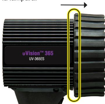
El filtro Borofloat transparente permanecerá dentro del protector. Para quitar el filtro (130089), jale alrededor del borde del soporte de goma de la cubierta/el filtro y estire el filtro hacia afuera. Para reemplazar o volver a insertar el filtro en el soporte de goma de la cubierta/el filtro, deslice el filtro dentro del canal del soporte. Manipule la cubierta de goma alrededor del filtro. Asegúrese de que el filtro se asiente de manera uniforme.
