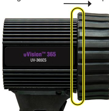
Der klare Borofloat-Filter verbleibt innerhalb des Schutzes. Um den Borofloat-Glasfilter (130089) zu entfernen, lösen Sie die Gummiabdeckung/Filterhalterung rundherum ab und drücken den Filter heraus. Um den klaren Borofloat-Filter auszutauschen oder wieder einzusetzen, drücken Sie den Filter in die Rille der Gummiabdeckung/Filterhalterung. Drücken Sie die Gummiabdeckung rundherum um den Filter an. Achten Sie darauf, dass der Filter gleichmäßig sitzt.
